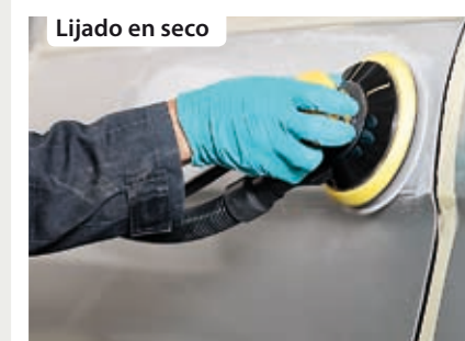
Matice la zona con el disco con sujeción de Mirka P 1000 o P 1200. Alternativas: Q.Silver® o Polarstar. Use un plato con almohadilla.
