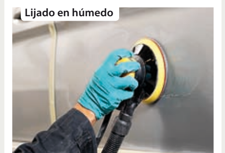
Matice la zona con Mirka Abralon® granulación 1000.
