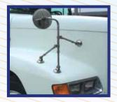
Refuerzo de áreas sometidas a mucha tensión donde se van a montar objetos, como espejos y agarraderas de puertas
