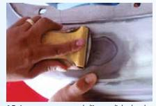
9.Deje que se cure antes de lijar y pulir los bordes del área de reparación delantera. Cubra con base de imprimación flexible #725. (Opcional: Use epóxido de acabado #891 MAXIM como recubrimiento final sobre la reparación del lado delantero antes de imprimar.)
