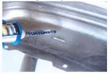
6. Aplique una capa ligera de Adhesivo de Uretano Rápido #887 MAXIM al lado trasero alrededor del área dañada inmediata dejando un borde de 3/4" de sustrato expuesto hasta el perfil. Aplique 1 ó 2 cordones de Adhesivo de Uretano Rápido MAXIM en el área dañada inmediata.
