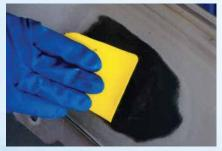
8. Moje inmediatamente el adhesivo de uretano rápido #887 MAXIM en el lado delantero del área de reparación. Llene el área restante del lado delantero con adhesivo de uretano rápido #887 MAXIM.
