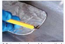
5. Corte un trozo de panel de reparación de propósito múltiple #828 MAXIM de tamaño suficiente para extenderse aproximadamente 3" más allá del corte o el área dañada en los cuatro lados. Redondee las esquinas del panel de reparación de propósito múltiple. Trace un perfil del parche en el lado posterior de la reparación.
